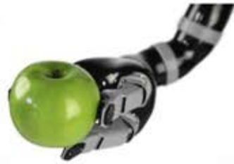
**JACO** est un bras robotisé d'assistance pour les personnes atteintes d'un handicap du haut du corps en fauteuil roulant électrique.
