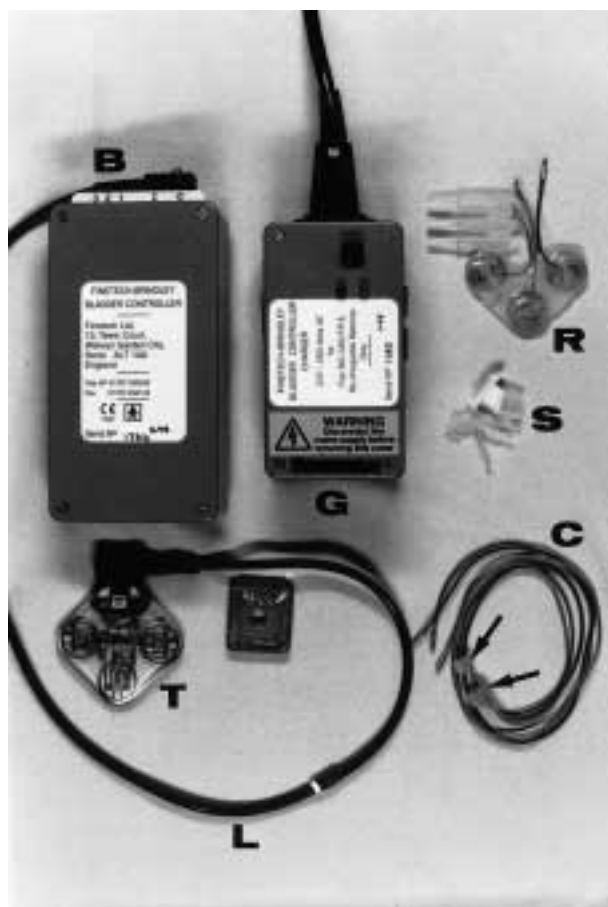
FIG. 1. — Le stimulateur (3-canaux) Finetech-Brindley (distribué par Neuro Control 1945 E, 97 th Street Cleveland, OH) est composé d'un équipement interne (implanté) et d'un équipement externe. L'implant est constitué des électrodes situées dans le piège à racines (flèches), des 3 câbles (C), du récepteur radio sous-cutané (R) et d'un dispositif d'étanchéité pour la fermeture dure (S). L'équipement externe est constitué de la boîte de contrôle (B), d'un câble (L), de l'émetteur radio (T) et d'un chargeur (G). Un nouveau matériel comportant une boîte de contrôle moins encombrante est maintenant disponible.
