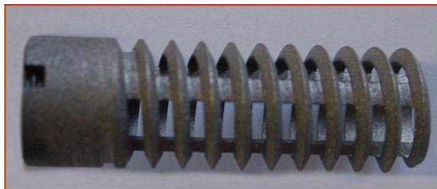
Figure 6 : vue macroscopique d'une cage intersomatique à visser.
