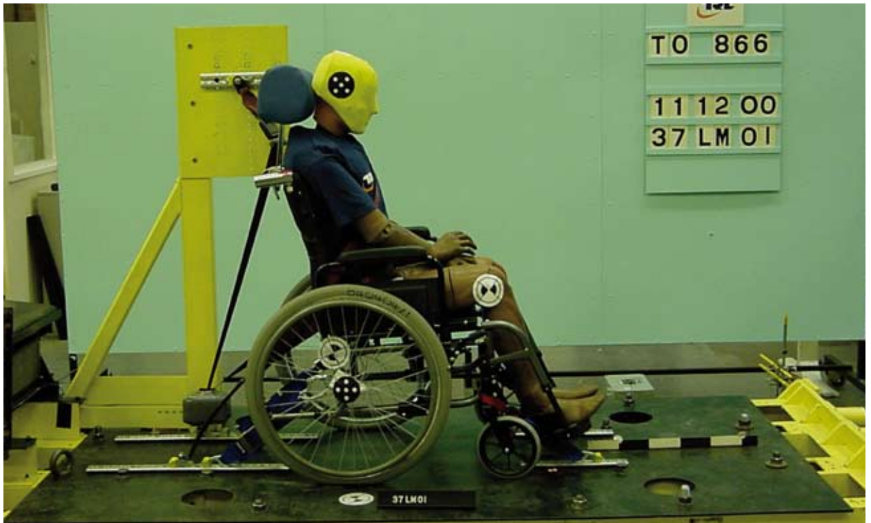
Fauteuil roulant arrimé aux rails, avant l'impact
