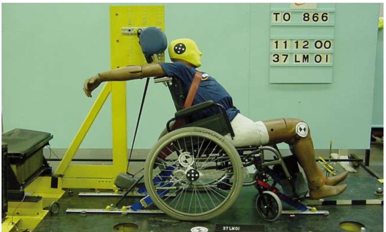
Fauteuil roulant arrimé aux rails, après l'impact
